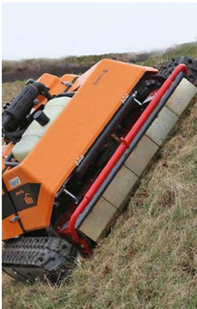
Die beiden funkfern gesteuerten RoboFlail One Modelle ermöglichen einfaches und sicheres Mulchen bis in steilste Hanglagen. Dank dem zwischen den Ketten liegenden Mähdecks kann in beide Fahrrichtungen gearbeitet werden. Zeitaufwändige Wendemanöver entfallen und es resultiert eine hohe Flächenleistung bei absolut bodenschonendem Arbeiten.
