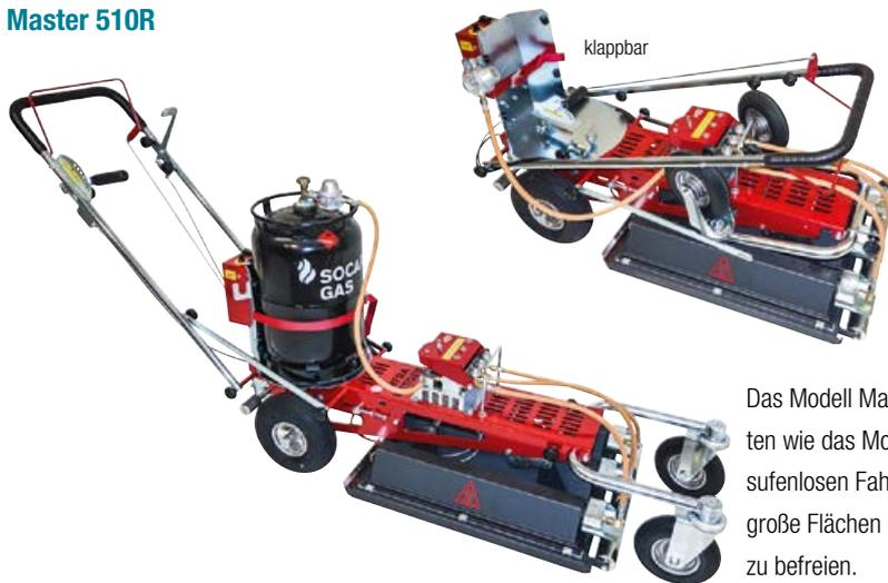
Das Modell Master 510R zeichnet sich durch die gleichen Eigenschaften wie das Modell Master 510 aus. Es ist jedoch zusätzlich mit einem stufenlosen Fahrtrieb ausgerüstet. Diese zusätzliche Funktion hilft große Flächen und Hanglagen ohne großen Kraftaufwand vom Wildkraut zu befreien.
