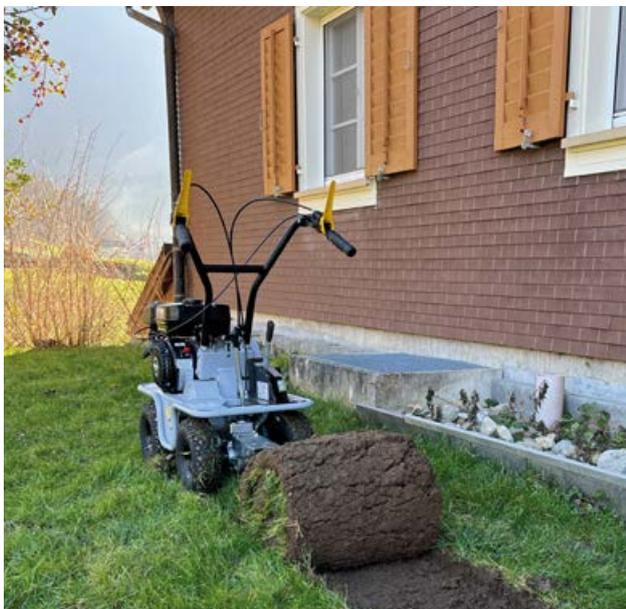
Robust und einfach in der Konstruktion und Ausführung schneidet der Sondenschneider einfach Bahnen. Der Antrieb des oszillierenden Messers wird getrennt vom Fahrtrieb geschaltet. Durch das leichte Gewicht und die einfache Bedienung kann der RS 3040 in jeder Anlage effektiv eingesetzt werden. Durch das werkzeuglose demontieren der Lenkholme ist der RS 3040 auch leicht im Kofferraum zu transportieren.
